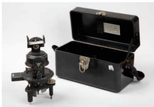
Astrokompas, který používali navigátoři britských bombardovacích letadel
