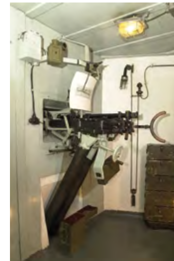
Dvojice těžkých kulometů vz. 37 ráže 7,92 mm v pravé střílecké místnosti MO-S 19 Alej
