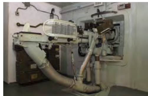
Działko forteczne wz. 36 kalibru 47 mm w prawej izbie bojowej MO-S 19 Alej i studni MO-S 19 Alej
