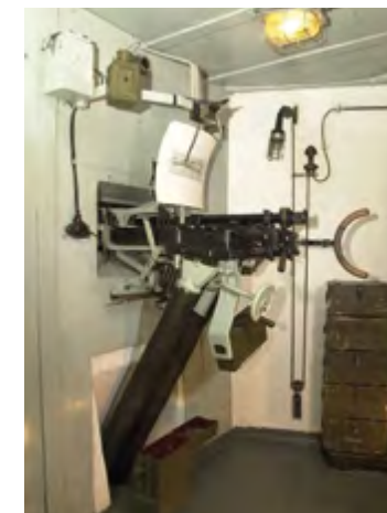
Para ciężkich karabinów maszynowych wz. 37 kalibru 7,92 mm w prawej izbie bojowej MO-S 19 Alej
