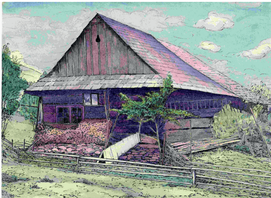
3. Roubený dům „kurlok“ z r. 1750, sedlová střecha s podlomenicí kryta šindelem, bedněný štít, pod „přídaškem“ ve štítu pověšeny obrázky svatých, Horní Lomná, kolorovaná kresba, 1951 (Etnografická podsběrka SZM, inv. č. N 6308)
