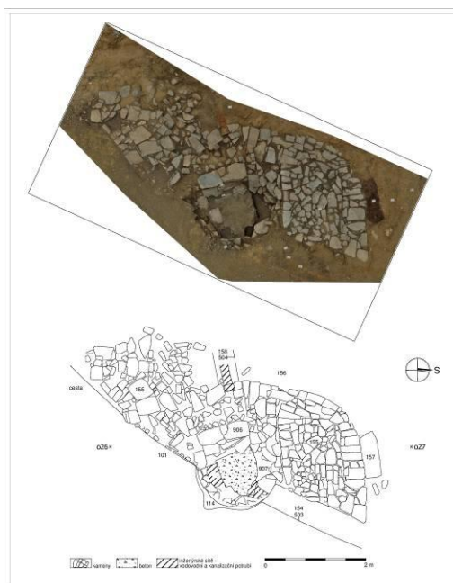
6. Sonda S6 - kašna ve východní části náměstí, kamenný základ a zpevnění povrchu v okolí – celková situace
