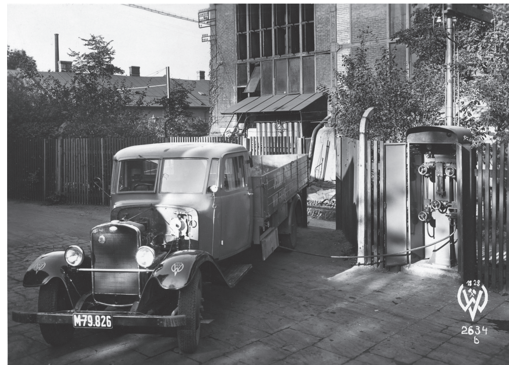
Obr. 5: Podnikový nákladní vůz přestavěný na pohon svítiplynem, 1936.
