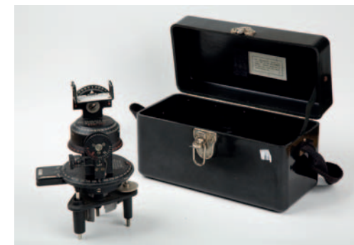
Astrokompas, který používali navigátoři britských bombardovacích letadel
