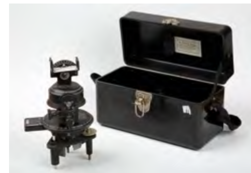
Astrokompas, který používali navigátoři britských bombardovacích letadel
