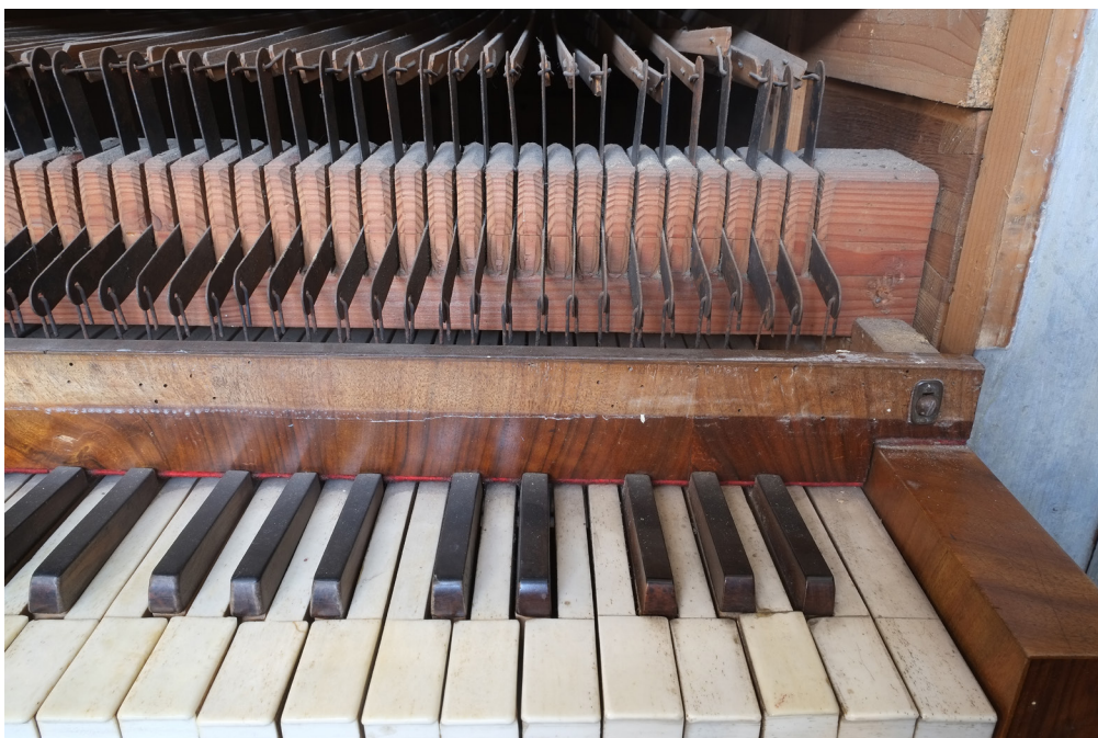
Lukavec u Fulneku, kostel sv. Jana Křtitele. Pohled na klaviaturu a úhelníkovou lištu. Na boku dorazové lišty viditelné kování pro vertikální posun lišty
