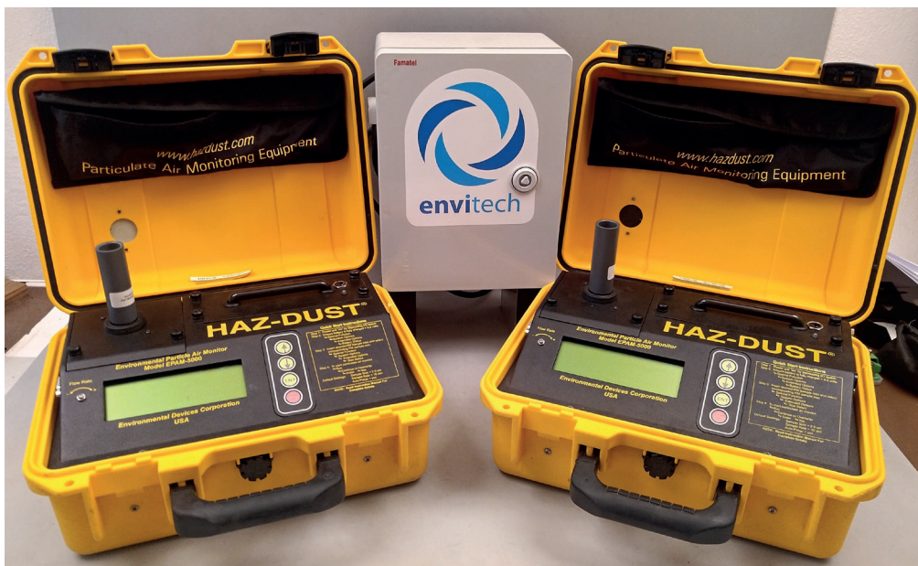
Obr. 4: Dvojice přístrojů Haz-Dust EPAM-5000 pro měření koncentrací prachových částí a monitorovací stanice Envitech pro měření látek znečišťujících ovzduší.
